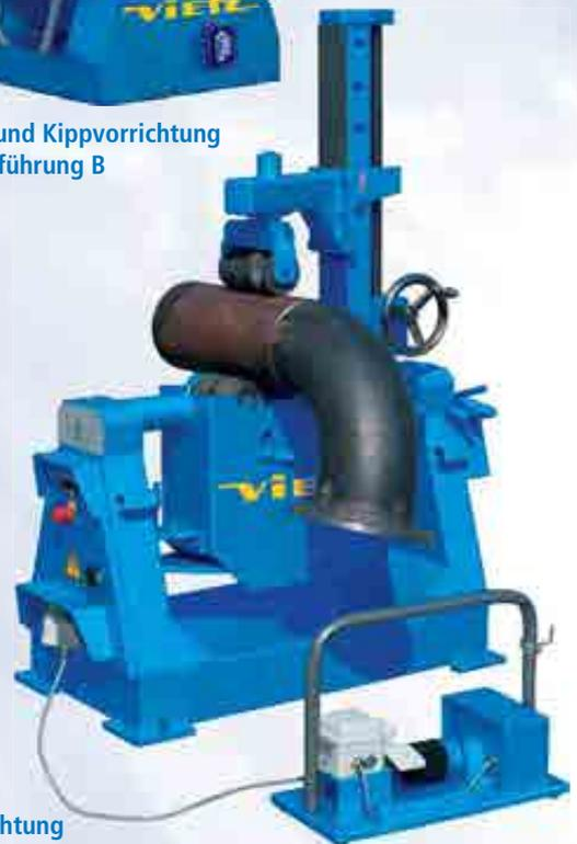
Spann-, Dreh- und Kippvorrichtung Typ U 500, mit optionaler Fußregelinheit
