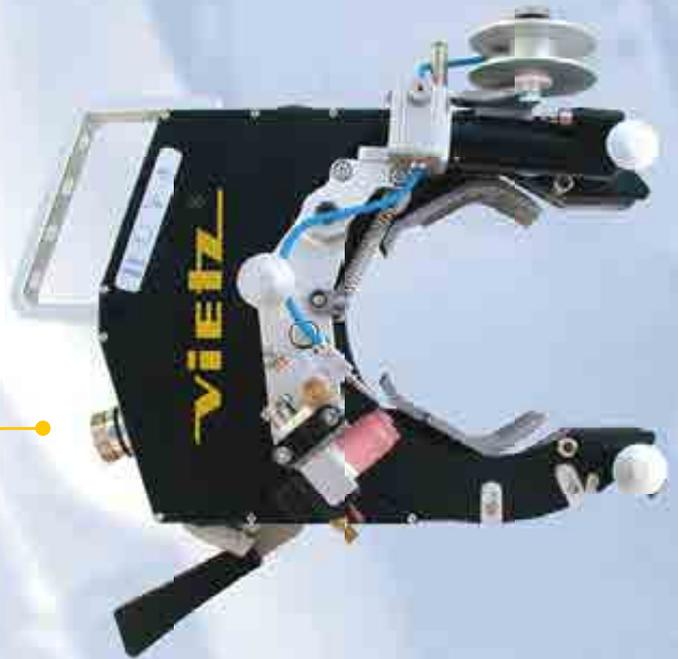
TP-Schweißzange mit Kaltdrahtzuführung
