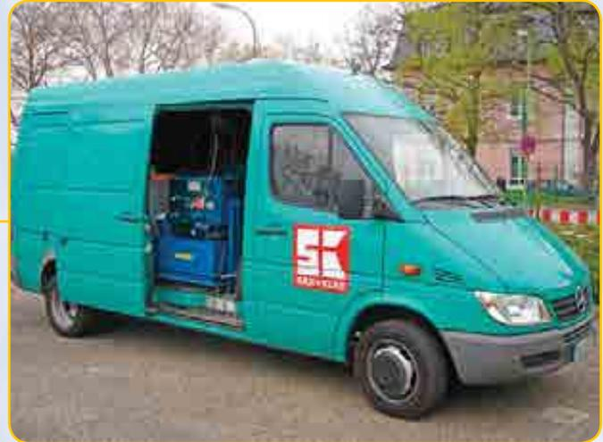
Spezialausführung GDV 320 stationär ohne Verhaubung eingebaut in einen Montagewagen der Firma Sax+Klee
