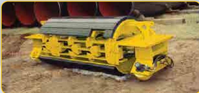
Hydraulisches Wedge-Type-Mandrel 40"-42" (mit Motor)
