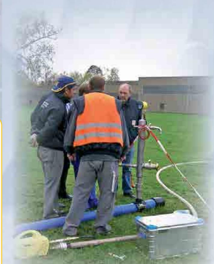
EVV-Druckprobenkoffer DPK III im Einsatz
