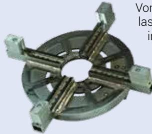
Vorschweißbünde mit sehr kurzen Verbindungsstutzen, lassen sich mittels eines **Vorschweißbund-Halters** in die vierte, unbewegliche Schweißbacke einspannen. Gleichzeitig lässt sich die dritte Schweißbacke mit den ersten beiden, beweglichen verbinden.
