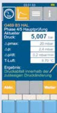
Bei einer Vielzahl neu verlegter Rohrleitungen ist eine Dichtheitsprüfung nach DVGW-Richtlinie zwingend erforderlich. So haben wir in den letzten Jahren ein System etabliert, das Ihnen keinen Wunsch offenlässt. Der digitale Druckprüfkoffer PMS 3000 ist ausgestattet mit hochauflösender Messtechnik, einem 4,3" Touchbedienfeld (auch als 7" erhältlich), einem Protokoll-drucker und diversen Anschlüssen für zusätzliche Messtechnik, Prüfpumpen oder Auslesegeräte.
