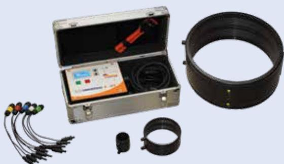
Das **UNIVERSAL 315 V1** kann E-Fittings für den Sanitärbereich bis zu einer Größe von DA 315 identifizieren und umgebungstemperaturkompensiert verschweißen. Das Gerät ist in einem robusten Koffer verbaut und im Lieferumfang erhalten Sie Schweißkabel für alle gängigen Muffenhersteller wie Geberit, Akatherm, Wavin, etc. Auch hier verfügt das Gerät über einen Speicher für bis zu 350 Protokolle.
