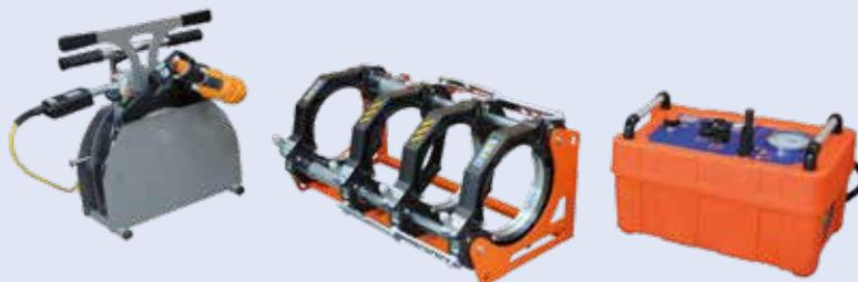
Alle Maschinen sind auch geeignet für die Verschweißung von Formteilen wie Bögen, T-Stücke und Flansche. Dazu lässt sich die dritte Schweißbacke mit den ersten beiden, beweglichen verbinden. In die vierte, fest Backe, wird dann das Formteil eingespannt.
